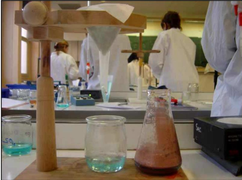
Filtration du mélange réactionnel
