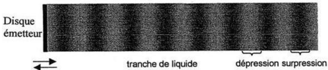
Lors du passage de l'onde dans une « tranche » de liquide, le phénomène de cavitation se produit si la puissance de l'onde est suffisante : des microbulles de vapeur dont le diamètre peut atteindre  $100 \mu\text{m}$  apparaissent. Les microbulles de vapeur sont transitoires. Elles implosent en moins d'une microseconde. Les ondes de choc émises par l'implosion nettoient la surface d'un solide plongé dans le liquide.
